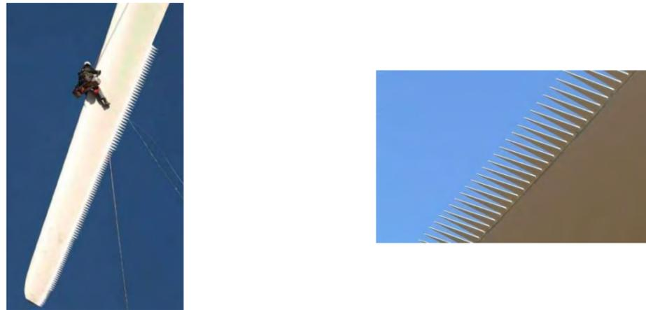
Photographies de pale dotée d’un système STE (peigne / dentelure)
